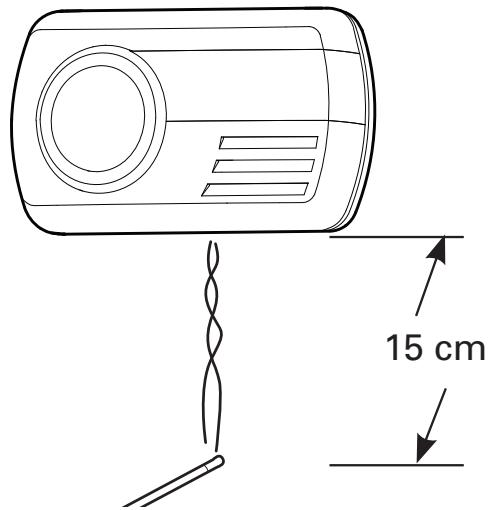
**Étape 1** Si le détecteur est installé au mur, décrochez-le de ses vis de montage.
