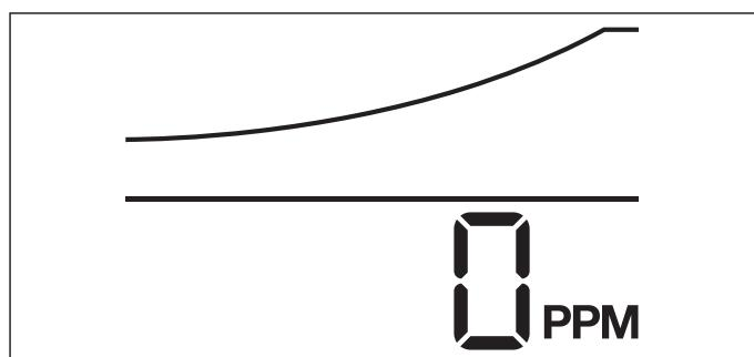
L'écran digital unique d'First Alert affiche la quantité de CO que le capteur détecte, indiquée en parties par million (PPM). Il est conçu pour indiquer les niveaux de 10 ppm à 999 ppm.
